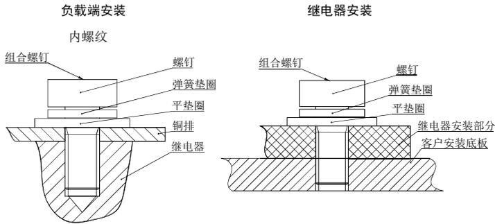
注:负载内螺纹M5孔深7.4mm
